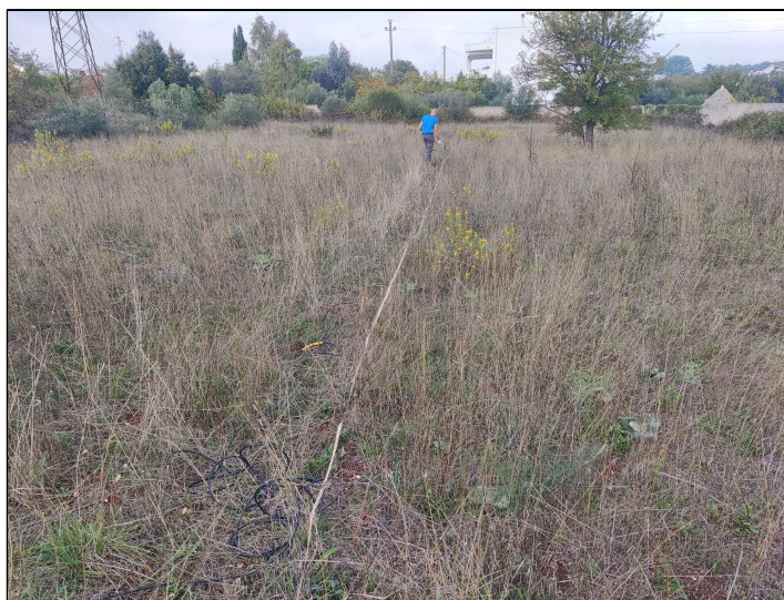
Fig. 21 – documentazione fotografica stendimento sismico MASW 3
