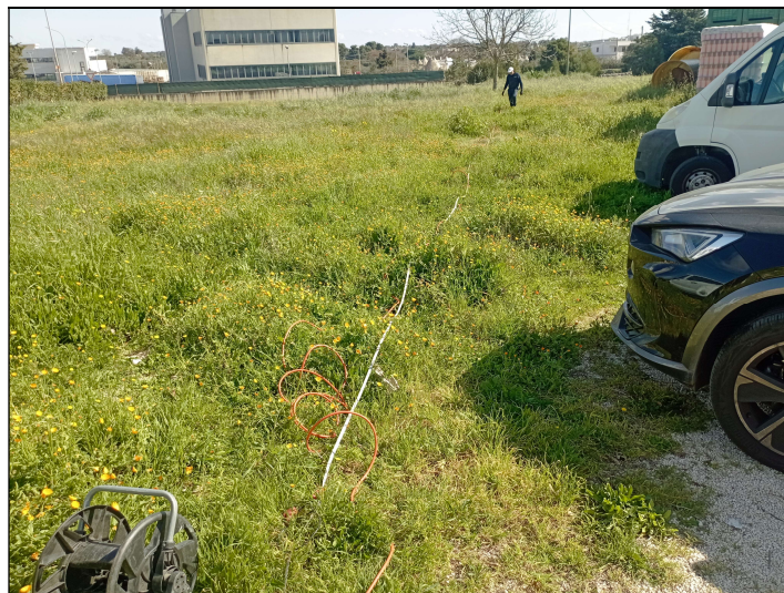
Fig. 19 – documentazione fotografica stendimento sismico MASW 1
